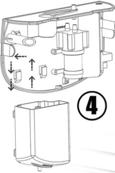
۵- اطمینان حاصل کنید که مخزن و اتصال شلنگ پمپ قبیل از قسرار دادن آن ایمن باشد.
